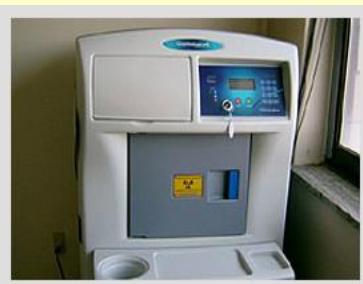
提供移植及免疫功能不全病人輸血安全之 血液照射儀
