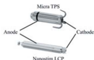
圖2：Micra TPS與Nanostim LCP無導線節律器（圖片引用來源：TRENDS IN CARDIOVASCULAR MEDICINE）
